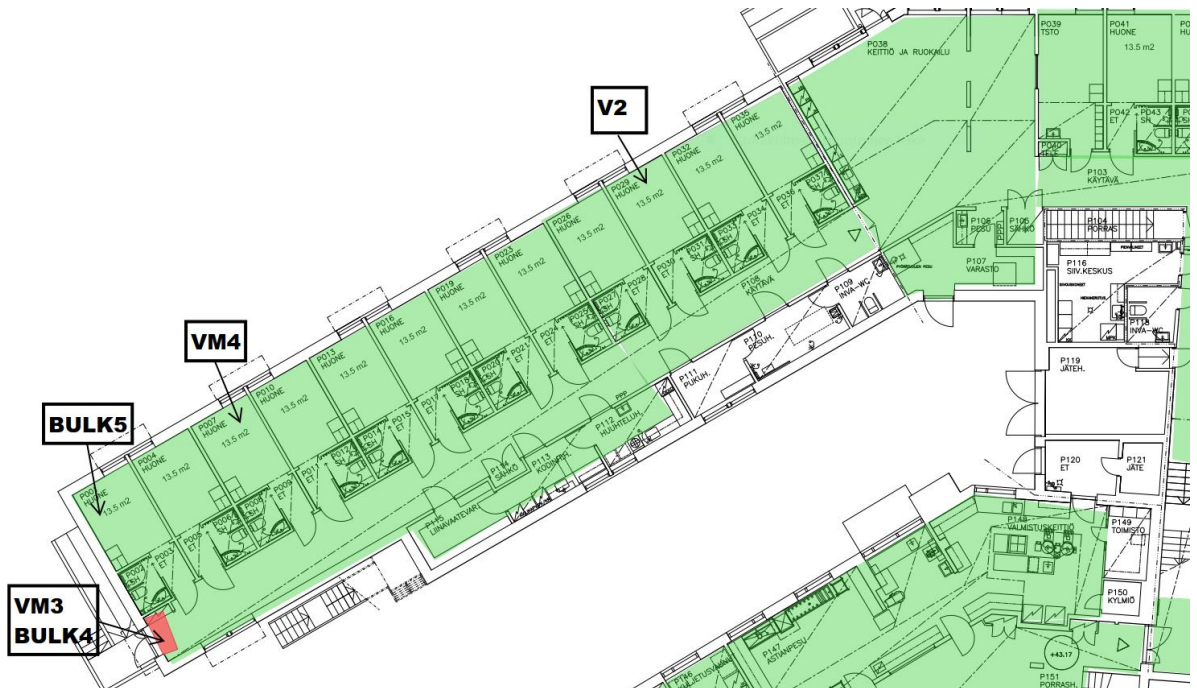
Kuva 4. Pintakosteustasot sekä näytteenottoaikat A-B- siiven eteläosa, pohjakerros. Viilto- mittauskohdassa VM3 kosteuspitoisuus maton alla oli korkea.
