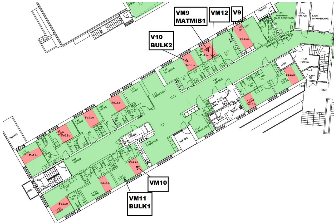
Kuva 10. Pintakosteustasot sekä näytteenottoapaikat D - siiven eteläosassa. Huoneissa, joissa pintakosteustasot olivat kohonneet, oli maton alla foliopaperimainen alusta.
